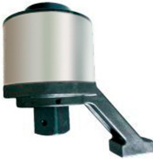
(扭矩\*转速=功率) 目前市场上各品牌的产品一般都是通过行星齿轮实现扭矩倍增，一般有放大5倍~125倍，最大输出扭矩可达5万Nm左右。2、力矩倍增器是由一圆周或行星齿轮组合在不同组合阶层来带动齿轮旋转出力，每一阶层齿轮扭矩放大倍率因子为5，常规比倍有：1: 4.2, 1: 16, 1: 21.5, 1: 26等系列。在行星型齿轮系统中，扭矩是经由中心齿轮输入和输出。由三个或四个行星齿轮与中心齿轮结合带动旋转。倍增器外壳内的圆周齿轮与环绕内部行星型齿轮接合，但相对与内部行星齿轮旋转而言，旋转方向是相反的。真实的扭矩倍增比准确性保证优于±4%。德国传动比扭矩倍增器图片
