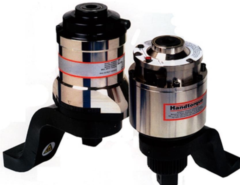
BACO扭矩放大器在原有1500Nm和2700Nm两款产品的基础上新增加了3000Nm和4500Nm两款大扭矩的新产品，扭矩倍增比较大26:1。扭矩倍增器{又称扭矩倍增器扭力放大器齿轮减速器扭力倍增器力矩放大仪增力器}，是一种可以为操作者提高扭矩的装置。由于输出端功率并不会超过输入端功率，所以输出回转数低于输入端回转数。（扭矩\*转速=功率）目前市场上各品牌的产品一般都是通过行星齿轮实现扭矩倍增，一般有放大5倍~125倍，最大输出扭矩可达5万Nm左右。德国传动比扭矩倍增器图片坚固的结构，容易保养，使用寿命长。
